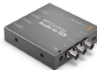
Este modelo permite integrar audio en cualquier fuente SDI en formato SD o HD con una resolución máxima de 1080p60. Dichas señales se reciben desde dispositivos tales como mezcladores y grabadores analógicos a través de conexiones de 0.25" para canales de audio analógico balanceado o AES/EBU. Este dispositivo ofrece una solución ideal cuando no es posible adquirir un modelo UHD.
