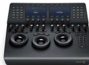
Panel de control profesional con un diseño compacto que incluye 3 esferas de gran precisión, 12 mandos giratorios para funciones esenciales y 2 pantallas de cristal líquido de 5 pulgadas, así como 8 mandos y 8 botones personalizables. Cuenta además con teclas especiales para alternar entre diversas herramientas, agregar nodos, realizar capturas y llevar a cabo todo tipo de tareas.
