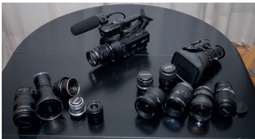
► Durante las pruebas aprovechamos para probar todo tipo de ópticas de cine, tv y fotografía en el equipo, pues el Variable Scan Mapping nos permite ajustar los tamaños si estos no llegan a cubrir el suficiente tamaño. Los resultados fueron plenamente satisfactorios con sencillas primes de Panasonic (20mm f1.7) y Olympus (digital 45mm f1.8 y analógica OM 50mm f1.4), así como con el zoom 12-40mm f2.8 que se incluye en promoción en estos momentos y los objetivos de cine PL que tuvimos la suerte de probar. Se trató sin duda de unas pruebas muy divertidas
