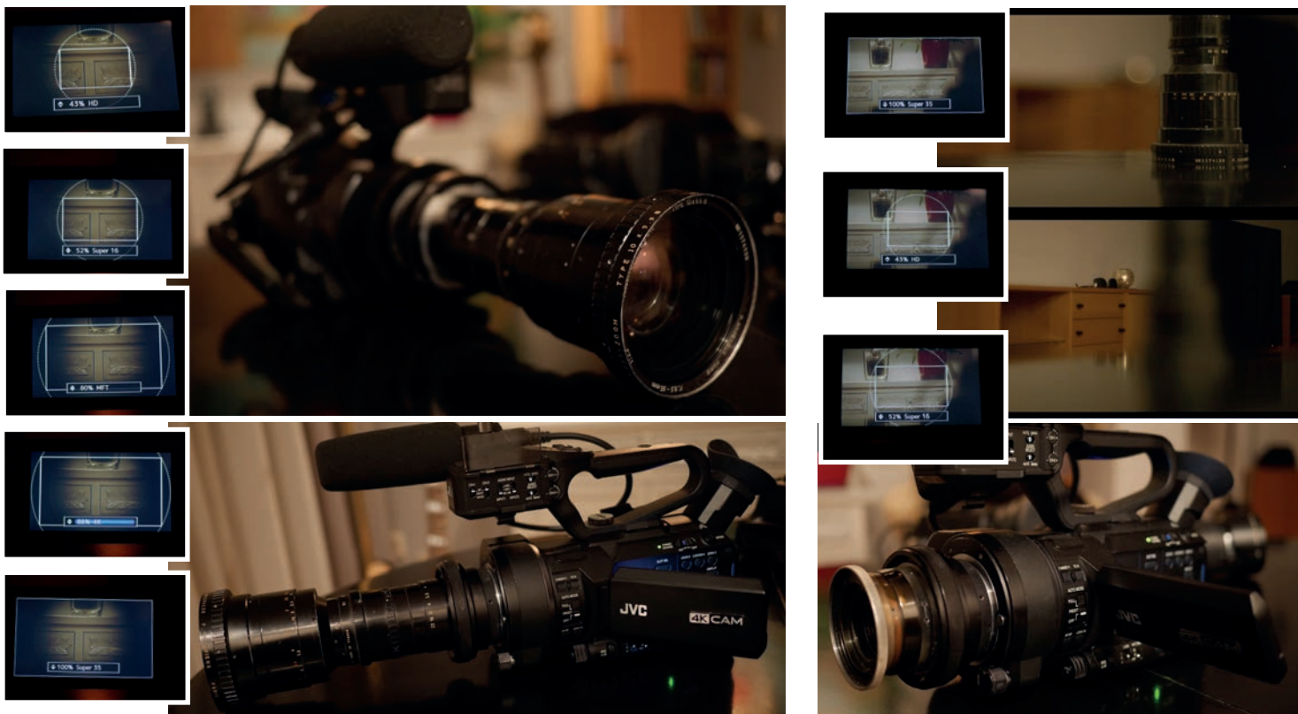
► Utilizar ópticas cinematográficas de montura PL de 16mm o de 35mm resulta tremendamente beneficioso teniendo el sistema Variable Scan Mapping de JVC. A la derecha vemos montada una antigua óptica PL LOMO Prime de 50mm de 35mm que ofrece un escaneo del 100% sobre el sensor Super35 sin ningún tipo de viñeteo, pudiéndola utilizar sin problemas en todo tipo de resoluciones (el Variable Scan Mapping permite hacer zoom con este tipo de primes si estamos trabajando en HD por ejemplo, ya que cuenta con un 57% más de campo hasta llegar al tamaño del Súper35). A la izquierda vemos montada una óptica zoom PL de 16mm de Angeniéux y en las imágenes pequeñas el viñeteo que produce en las correspondientes resoluciones. No sería operativa para resoluciones Super35, 4K y Micro 4:3, como se puede apreciar, pero es absolutamente operativa para captar en resoluciones Super16, 2K, y por supuesto en HD y SD sin tener que ampliar en postproducción. En DSLRs hemos visto en numerosas ocasiones como se ajusta el viñeteo con la opción de zoom digital x2 o x4, sin embargo lo que ofrece JVC es exactamente la misma calidad del sensor, pero eligiendo la parte que nos interesa en cada momento para nuestra óptica. ¡Fantástico!
