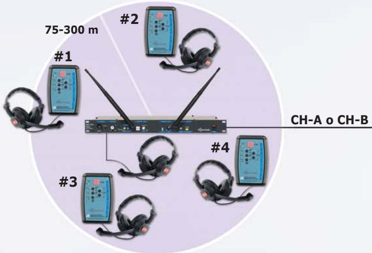
Es sistema se puede expandir conectándolo directamente a un sistema de Intercom por cable como el mostrado por varias petacas EM-201.
